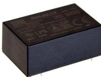
Рисунок 6 - IRM-03-5 AC/DC преобразователь на 5V
