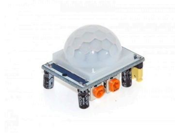
Рисунок 4 - Датчика движения HS-SR501
