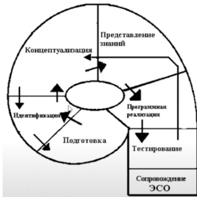
Рисунок 1 — Жизненный цикл экспериментальной системы (ЭС)
